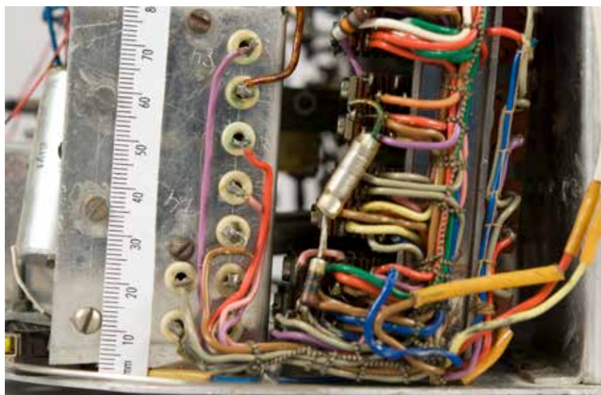
Detail der elektromechanischen Schildkröte »Hinz«: Runde Keramikisolatoren mit grünlichem Korrosionsprodukt. © J. Sawitzki
