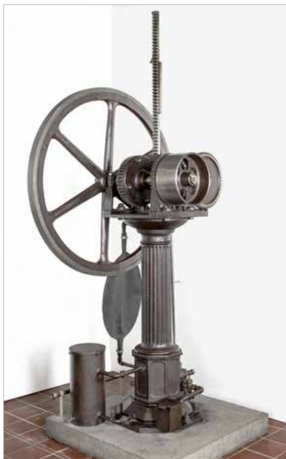
Wieder lauffähig: Die atmosphärische Gasmaschine von Otto und Langen von 1867 wurde wieder in Betrieb genommen. Sie wiegt ca. 900 Kilogramm und leistet etwa 350 Watt. © Deutsches Museum Fotoatelier, Hans-Joachim Becker
