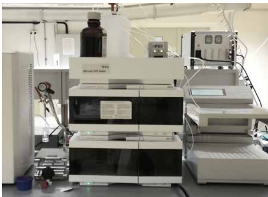
Das neu erworbene System für die Gel-Permeations-Chromatographie im Labor der Restaurierungsforschung. © A. Micheluz
