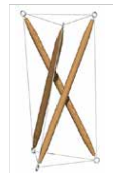
Ein simples Tensegrity-Element zur Verdeutlichung des Kernprinzips: Die Stäbe berühren sich gegenseitig nicht. © Bob Burkhardt; CC BY 2.5
